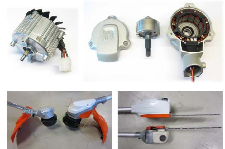
▶ 자체 개발한 고효율 BLDC 모터 우리의 BLDC모터는 소형, 컴팩트형으로 케이스 내부에 센서등을 모두 넣었습니다. 타사의 제품들은 모터의 센서등 부속품이 모터 밖으로 노출되어 있어 별도의 케이스를 가지고 있고 따라서 무겁고 부피가 큼니다.
