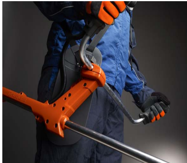
▶ 높은 볼혼(소뿔) 핸들은 트리머 헤드를 들 때 팔로 들지 않고 몸에 붙여 당기는 피봇 회전을 가능하게 하여 팔에 부담을 주지 않아서 경사의 작업을 쉽게 합니다. 경사지에서의 작업이 쉽습니다.
