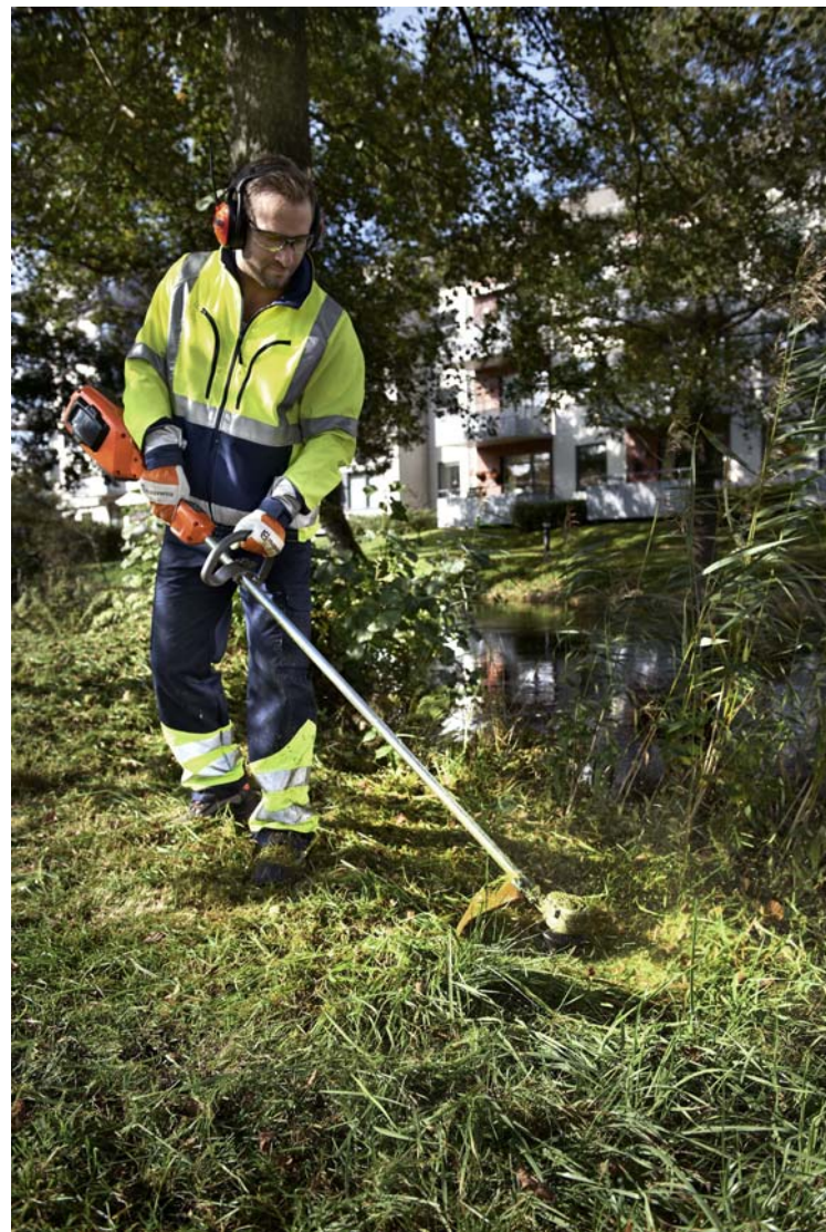
양방향 회전 보도 등에 풀 조각이 떨어지지 않도록 트리머 헤드의 회전방향을 바꿀 수 있습니다.
